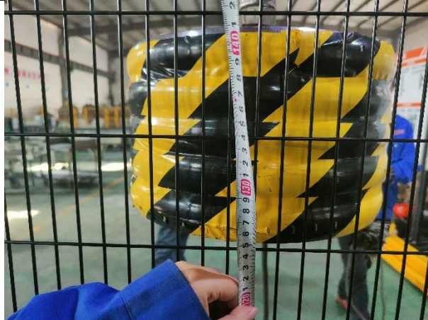
Initial height of pendulum above the ground: 1333 mm 初始摆锤离地高度：1333 mm
